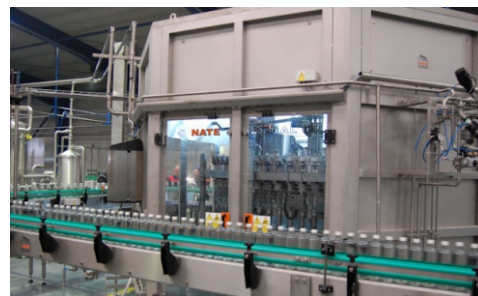
Repasovaný plnič VERAL 64 s krytováním PEPSICO, Vitaco Impex s.r.l. Covasna, Rumunsko
